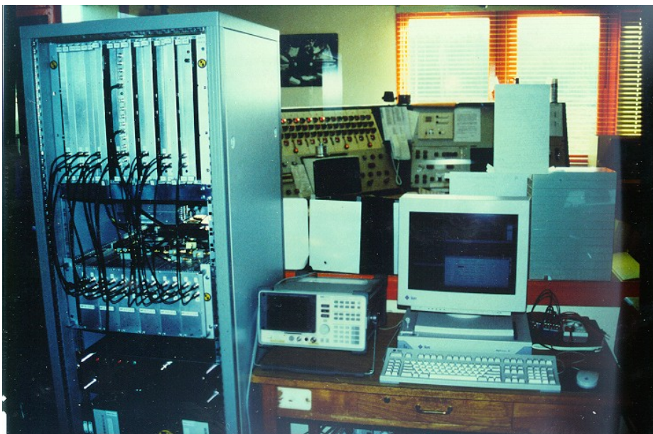
FIG. 2.8 – Vue du dédisperseur à banque de filtres NBPP (Navy Berkeley Pulsar Processor) installé en 1996 dans l’ancien laboratoire focal du radiotélescope de Nançay. Doté de 96 canaux de fréquences de 1.5MHz, cette instrumentation a principalement été utilisée en collaboration avec des collègues du Naval Research Lab de Washington, DC dans le cadre d’un programme de recherche de nouveaux pulsars dans le plan galactique.
