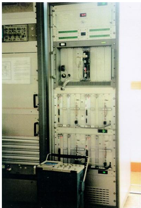
FIG. 2.6 – Vue du dédisperseur à oscillateur balayé à 4 voies à DDS installé à Nançay en 1996 et utilisé jusqu'en 2005. Deux versions, l'une à 1 voie à VCO asservi (1988) et l'autre à 4 voies à VCO asservis (1991) ont précédé ce modèle.
